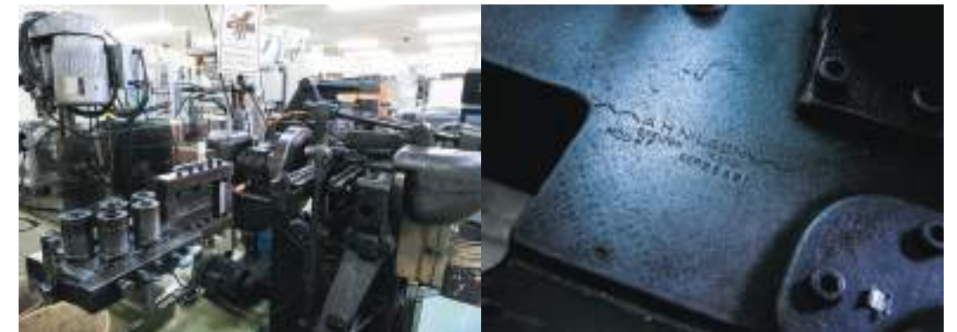
▲富士発條 最古の設備AHニルソン製スライド式加工機
